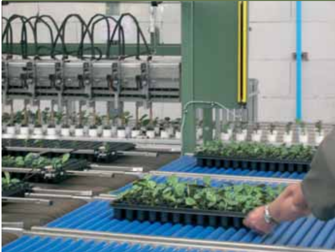
De productie werd aanzienlijk verhoogd bij de ingebruikname van een computergestuurde camera-sorteerlijn.
